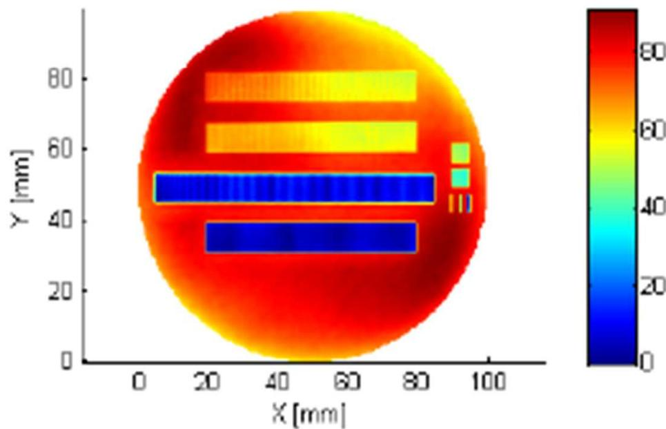
Be6untergr.wve PV: 37,1 nm RMS: 8,0 nm
